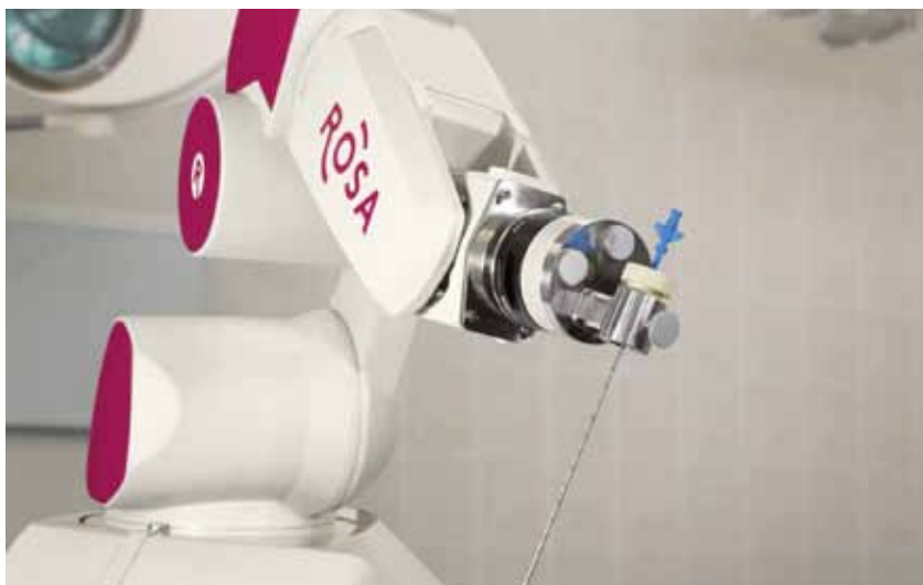
Robot Rosa d'assistance aux gestes chirurgicaux, Medtech
